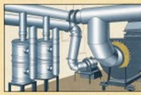
Фильтровентиляционное оборудование убежища
