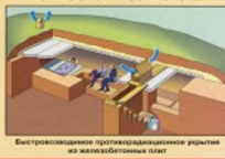
Быстровозводимое противорадиационное укрытие из железобетонных плит
