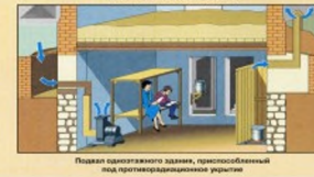
Подвал одноэтажного здания, приспособленный под противорадиационное укрытие
